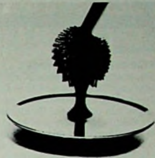
Deze twee foto's uit het Philips Natuurkundig Laboratorium te Eindhoven tonen hoe een zwarte vloeistof opstijgt uit een schaal en een „goedendag“-kop vormt aan het eind van een er boven gehouden staafmagneet. De oorzaak van dit merkwaardige gedrag is te vinden in de samenstelling van de vloeistof: in een olie is uiterst fijn verdeeld magnetisch ijzeroxide gesuspenderd.
